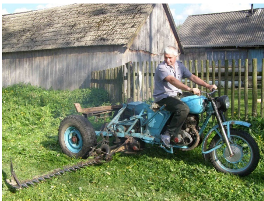
Саморобний транспортний засіб (триколісна “дига” з мотоциклетним двигуном) з косаркою. За кермом майстер “диги” Микола Круп’я. Сеанс ОЕК_AV_20090523 vovczak_seans06. Село Лімна
