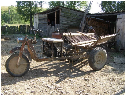
Саморобний транспортний засіб (триколісна “дига” з мотоциклетним двигуном) з “драбинами” для перевезення сіна. Село Хашців.
