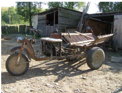
Саморобний транспортний засіб (“дига” з мотоциклетним двигуном) з “драбинами” для перевезення сіна. Село Хашів.
