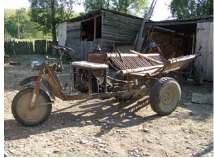
Саморобний транспортний засіб (“дига” з мотоциклетним двигуном) з “драбинами” для перевезення сіна. Село Хашців.
