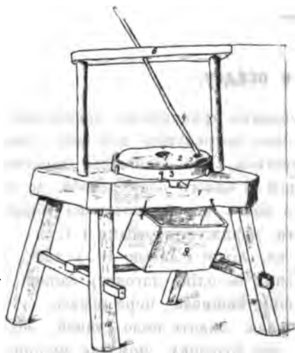
90. Жорна. 1. Колода, у ній спідник; 2. по- верхник; 3. обичайка; 4. погонач; 5. каганець; 6. кросна; 7. прогорниця; 8. мучник; 9. корито; 10. лаба.
